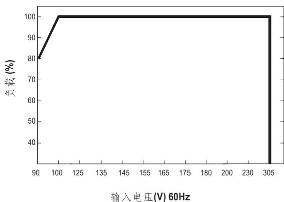
※ 低输入电压情况下需减额输出
